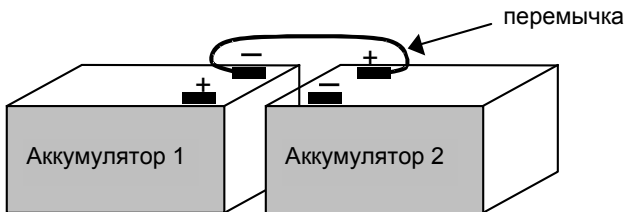
Рисунок. 2 Схема соединения аккумуляторов перемычкой
