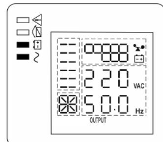
Рисунок 9 — состояние ЖК-дисплея и индикаторов в режиме «РЕЗЕРВ»
