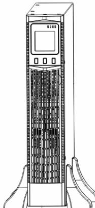
**Изделие выполнено** в металлическом корпусе с перфорированной пластиковой передней панелью, на которой расположены ЖК-дисплей, светодиодные индикаторы и кнопки управления (см.раздел «ОПИСАНИЕ ЖК—ДИСПЛЕЯ» и рисунки 1 и 3).
