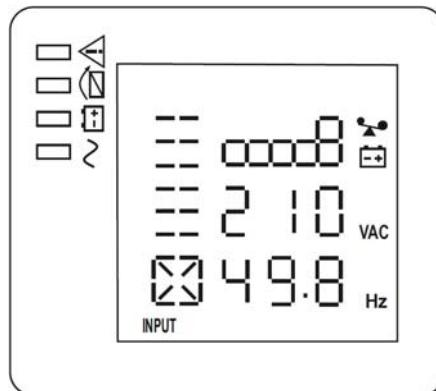
**Параметр «BATTERY»:** в режиме «РЕЗЕРВ» отображается напряжение на клеммах АКБ и степень ее заряда в процентах (степень заряда АКБ рассчитывается приблизительно на основании величины напряжения на ее клеммах), в режиме «ОСНОВНОЙ» отображается напряжение заряда АКБ.
