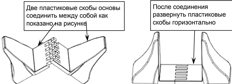
Рисунок 5 - Сборка пластиковых основ для вертикальной установки изделия
