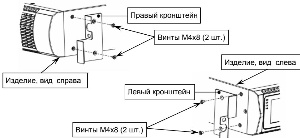
Рисунок 6 — Установка кронштейнов на корпус изделия
