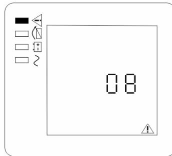
Рисунок 10 – пример отображения кода неисправности на ЖК-дисплее
