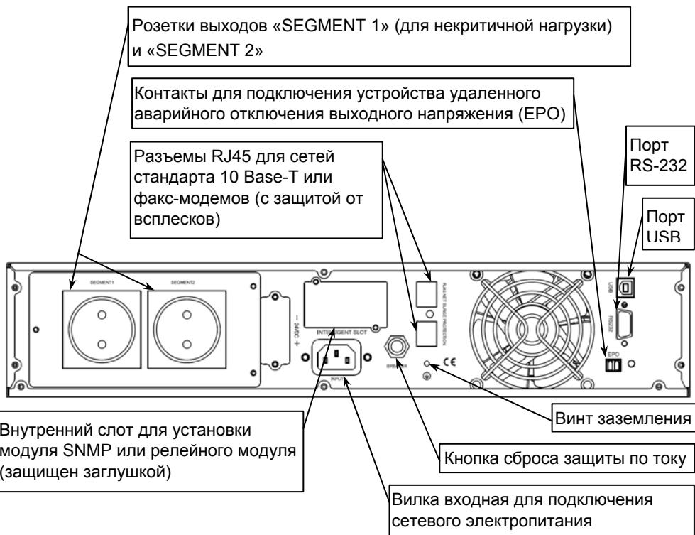
Рисунок 2 – Общий вид задней панели изделия
