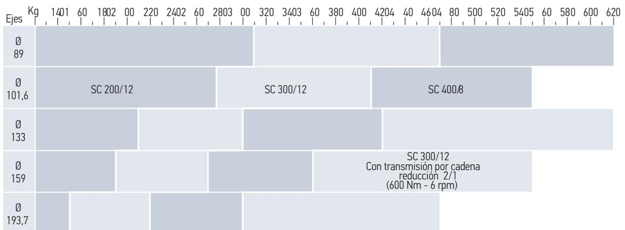
Una vez elegido el eje de enrollamiento, seleccione el operador en función del peso total del producto a motorizar.
