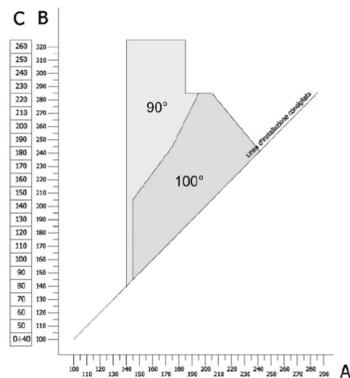
На Графике 4 показаны возможные значения точек монтажа А, В и С с углом открытия от 90 до 100 градусов для привода **Wingo5000**.
